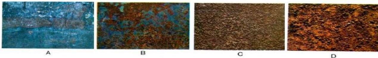
Figura 09 – Graus de oxidação pela norma ISSO 8505-1
